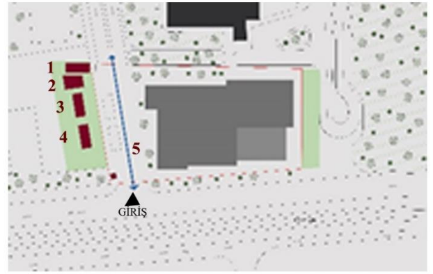
1- Metal Atık Depolama 3- Dönüştürülemez Atık Depolama 5- Araç Sirkülsayon Hattı 2- Geri Dönüştürülebilir Atık Depolama 4- Diğer Depo Alanı
