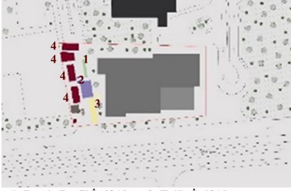
1- Demir-Profil İstif Alanı 3- Tuğla İstif Alanı 2- Kum İstif Alanı 4- Atık Depolama Alanları
