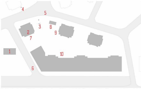
1-yönetim /satış ofisi 2-su deposu 3-su dağıtımı 4-elektrik panosu 5-2.giriş araç vs. 6-ana giriş 7-çimento depolama ve yapımı 8-işçi konteynırı 9-kalıp ve ahşap işleri 10-demir fayans vs. kesimi
