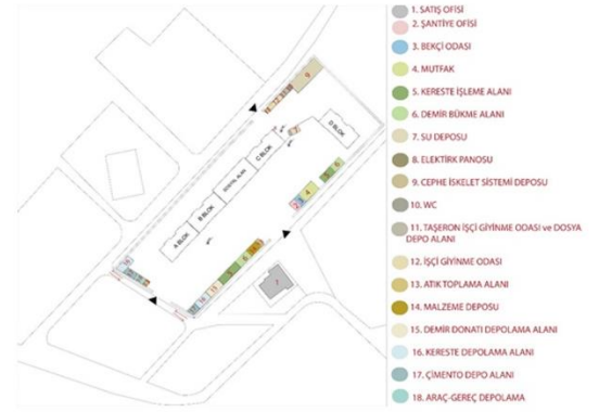
Şekil 6. Şantiye 4'e ait mevcut ve öneri şantiye yerleşim planı (Dinçel, 2019) Figure 6. Current and proposed site layout plan of construction site 4 (Dinçel, 2019)
