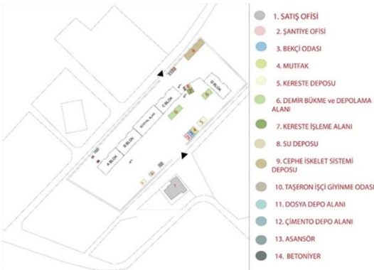
Şekil 6. Şantiye 4'e ait mevcut ve öneri şantiye yerleşim planı (Dinçel, 2019) Figure 6. Current and proposed site layout plan of construction site 4 (Dinçel, 2019)
