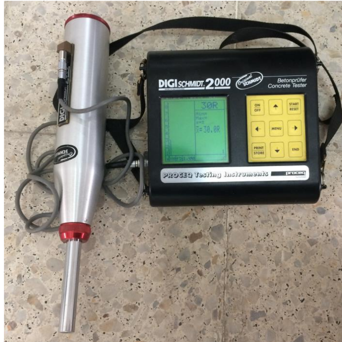
Şekil 8. Kayaç dayanımı bulmak için kullanılan L Tipi Dijital Schmidt çekici
