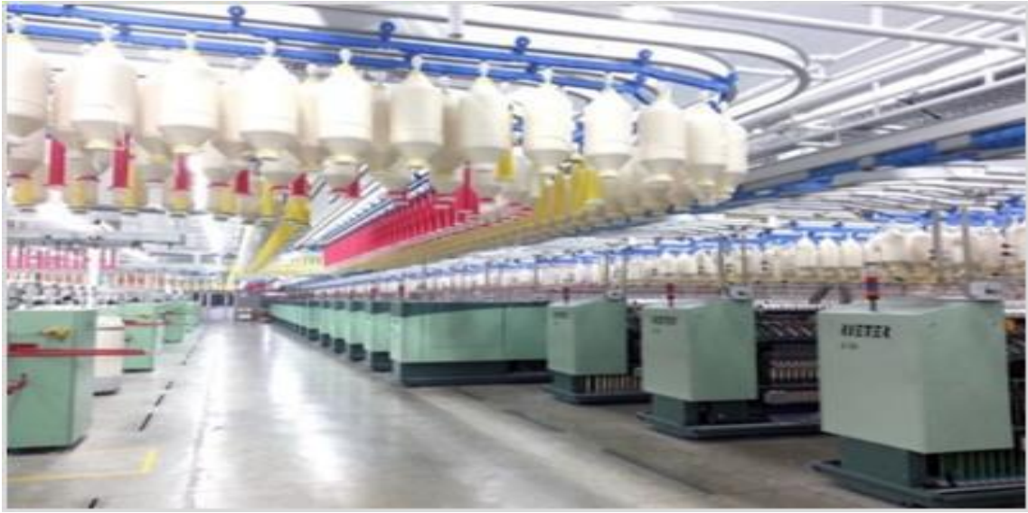
Şekil 5. İplikhanede fitil yumaklarının otomatik taşınması
