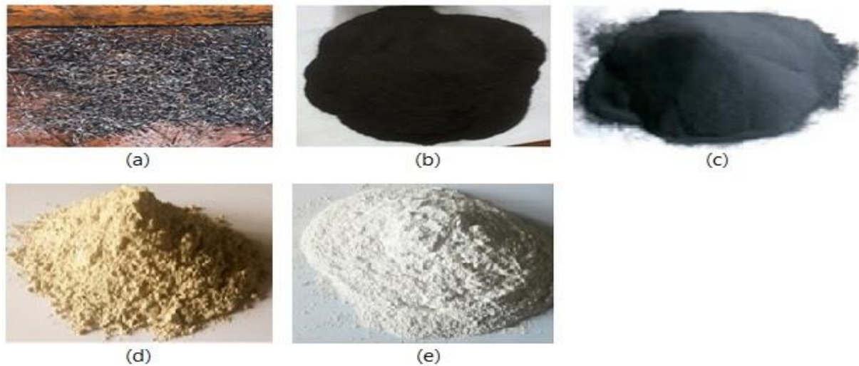
Fig. 1. Input materials (a) mild steel chips (b) 105- \mu\text{m} mild steel particles (c) 53- \mu\text{m} Silicon carbide particles (d) 90- \mu\text{m} bentonite (e) 90- \mu\text{m} magnesia
