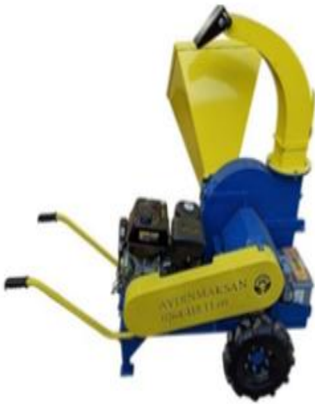
Şekil 2. Denemelerde kullanılan dal parçalama/öğütme makinası
