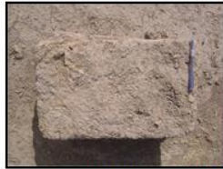
Foto 3. Kümbet Evlerde Genel Olarak Tercih Edilen 30x50x10 Ebadındaki Kerpiçler.
