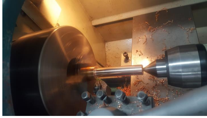
Şekil 1. Elektrolitik bakır malzemenin deneysel çalışma için hazırlanma görüntüsü
