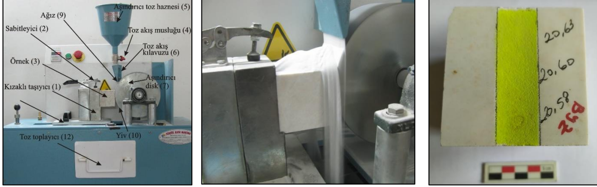
Şekil 3. Dikey aşınma deney cihazı ve deney işlemlerinden görünümüler.
