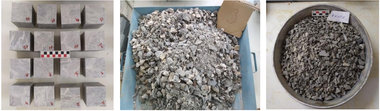
Şekil 2. Çalışmada kullanılan küp şekilli ve kırıcıda öğütülerek agrega boyutlarına indirgenmiş örneklerden görüntümler.
