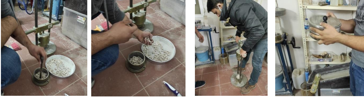
Şekil 4. Agregalar üzerinde gerçekleştirilen darbe dayanım deneyinden görüntüler.
