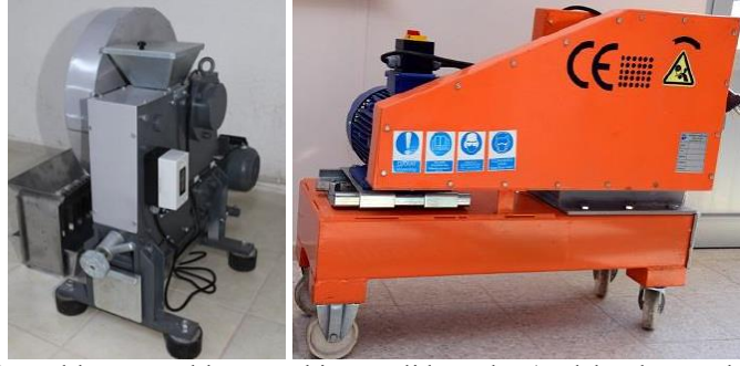
Şekil 3. Farklı ağız açıklığına sahip çeneli kırıcılar (Çolakoğlu ve ark., 2021)
