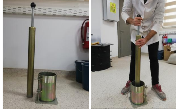
Şekil 5. Düşen tokmakla kompaksiyon deney aletleri ve tokmağın uygulanışı
