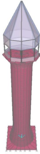
Şekil 2. Seyir kulesinin SAP2000 programındaki modellemesi (Figure 2. Modeling of the observation tower in the SAP2000 program)
