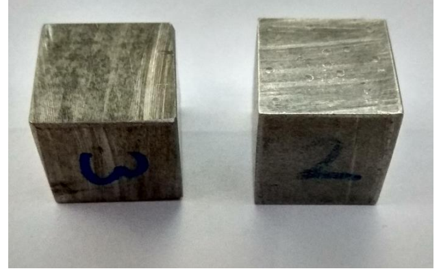
Şekil 4. AA5083 MDF numuneleri: MDF öncesi ısıtıl işlem yapılmış numune (solda), 4 Paso MDF uygulanmış numune (sağda)
