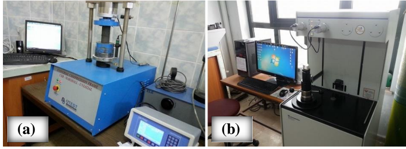
Şekil 3. TEBD ünitesi (a) ve MIP cihazı (b) (Compressive strength (a) and MIP (b) devices)
