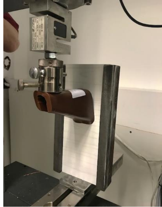
Şekil 10. Zwick test cihazında plastik ayakların mukavemet ölçümü
