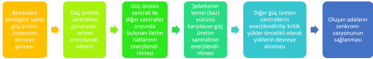
Şekil 4. Güç sisteminin yeniden başlatma özelliği ile enerjilendirilmesi
