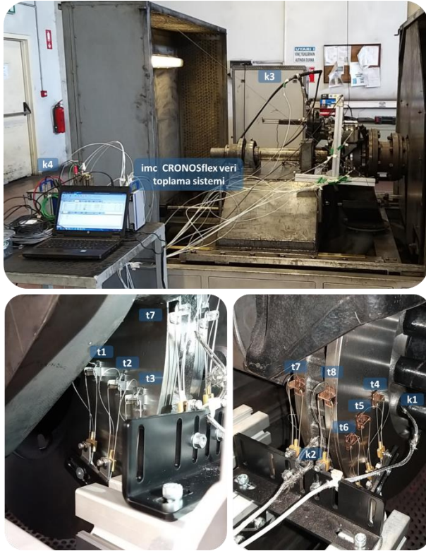
Şekil 2. Soğuma süresi deney düzeni (Cooldown period test setup)
