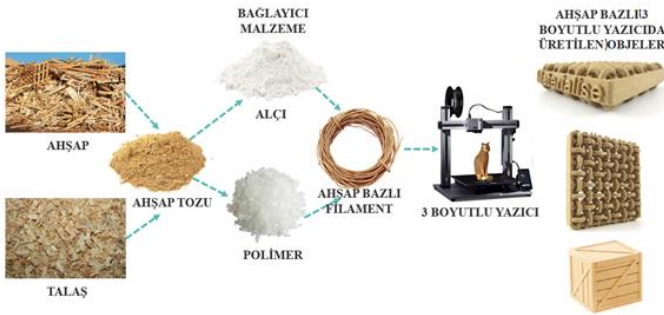
Şekil 1. Ahşap ve talaşın 3D yazıcılarda kullanım süreci akışı temsili görüntüsü; Ahşap bazlı malzemelerden 3D yazıcıda üretilen objeler (URL 1).
