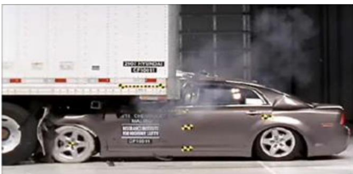
Fig. 1 2010 Chevrolet Malibu Front into 2007 Hyundai Trailer Rear Crash Test (Wegmuller, von der Weid, 2011)
