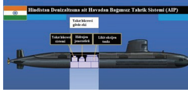
Şekil 3. Havadan Bağımsız Tahrik Sistemi (Sutton, 2020)
