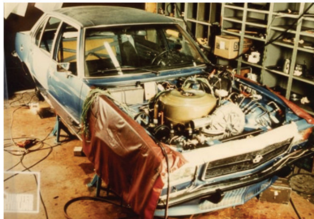
Şekil 17. Opel-Record araçta kullanılan P40 Stirling motoru (D. Nilsson & Engineer, 2014)
