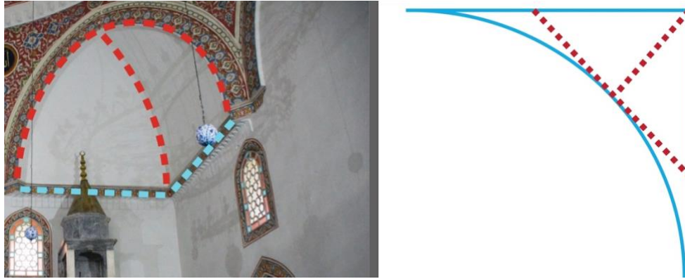
Şekil 4. Solda mavi hat üç köşeyi oluşturan duvarlar, kırmızı hat tromp kemerleri. Sağda aynı elemanların plan kesit görünüşü.
