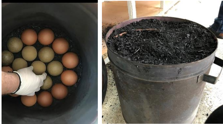
Görsel 12. Deney numunelerinin Krom Nikel kaba yerleştirilmesi (Fotoğraf: Erdem Aybar)
