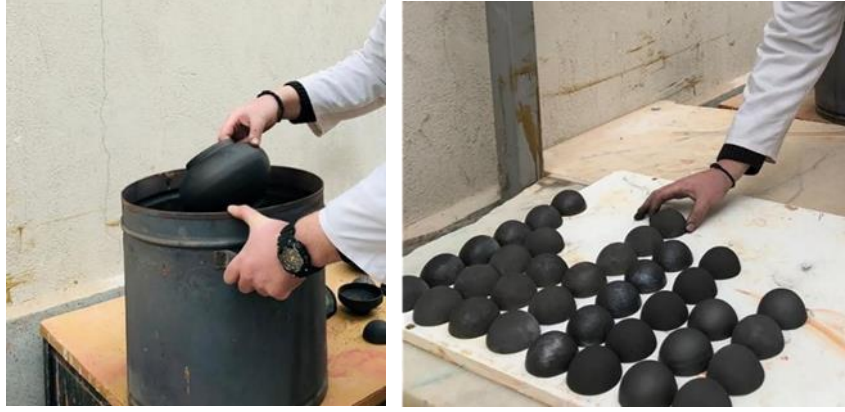
Görsel 10, 11. Pişirilmiş deney numunelerinin fırından ve krom nikel kaptan çıkarılarak dizilişi (Fotoğraflar: Erdem Aybar)
