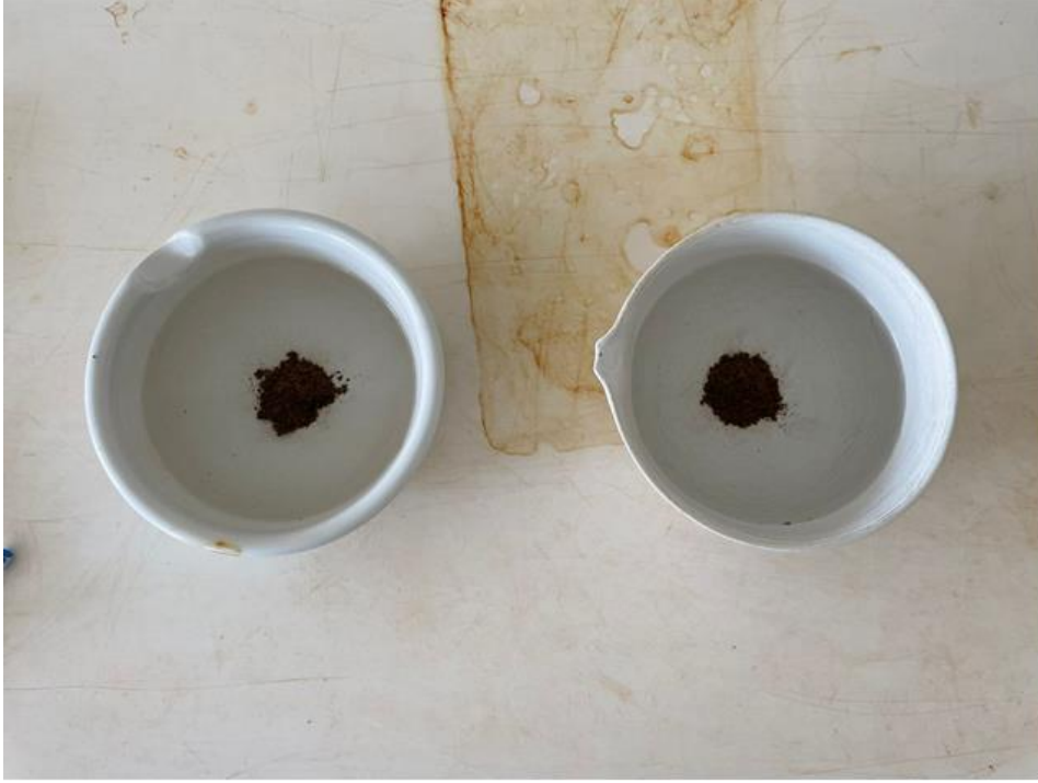
Şekil 9. Günkırı tandır kilinin dağılma deneyi görüntüsü
