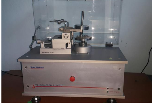
Şekil 1. Aşınma cihazı (UTS 10/20 Tribometer)
