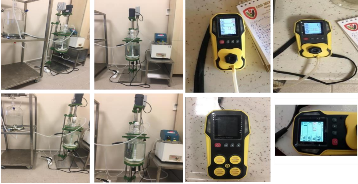
Şekil 1. 5 litrelik hacme sahip kesikli anaerobik biyoreaktör ve biyogaz ölçüm cihazı
