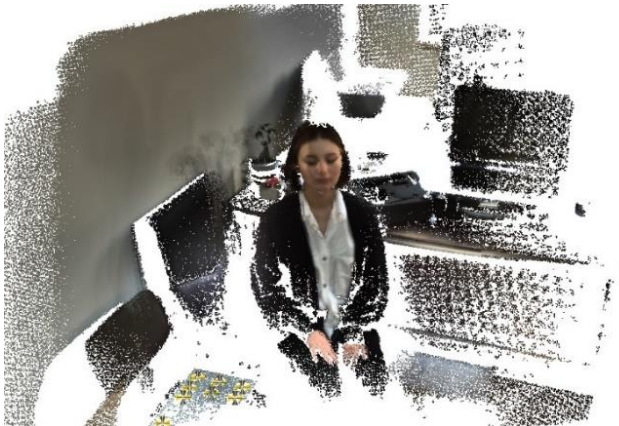
Şekil 5. FARO Freestyle 3B Tarayıcı ile Oluşturulan Nokta Bulutu Modeli
