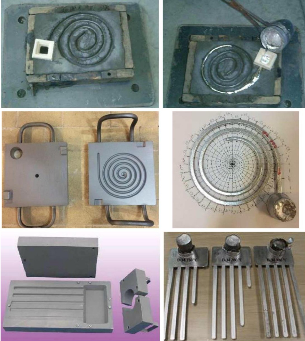
Şekil 16. a) Kum spiral kalıba akış deney dökümü [27], b) Kokil spiral kalıba akış deney dökümü [28], c) akışkanlık testi kalıbı ve numunesi [29]
