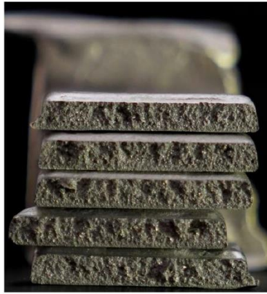
% 10 hurda ilaveli temizleme öncesi
