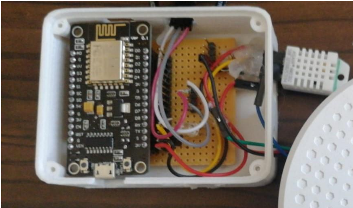
Şekil 8. Klimanın kontrolü için tasarlanan devre
