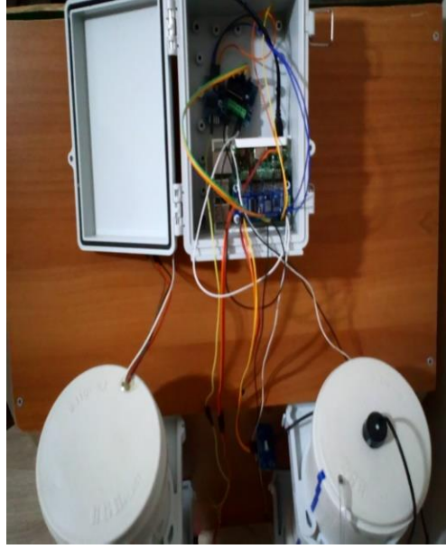
Şekil 3. Akıllı hayvan barınak sisteminin kontrol devresi
