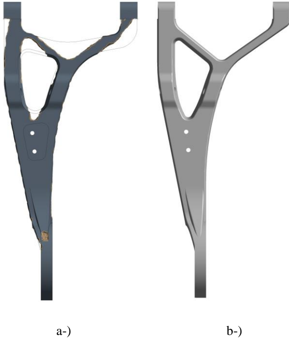
Şekil 7. a-) Topoloji optimizasyonu sonucu ve ondan elde edilen b-) yeni geometrinin karşılaştırılması.
