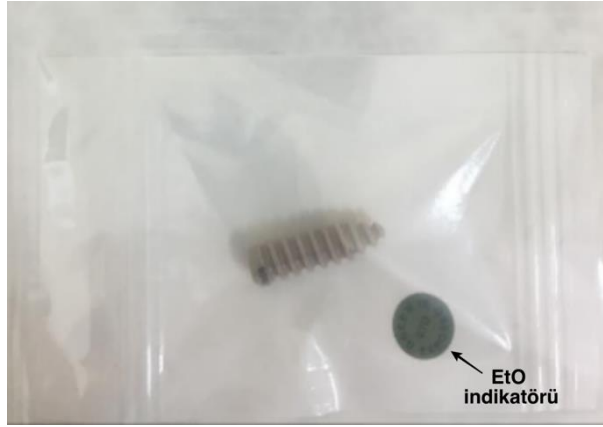
Şekil 3. Eto İle Steril Edilmiş Ambalaj İçerisinde PEEK Dental İplant (Ambaj İçerisine Yapıştırılmış Renk İndikatörü Eto Gazına Maruz Kaldığında Yeşil Renge Dönerek Ambalajın Gazı Geçirdiğini Kanıtlamaktadır).
