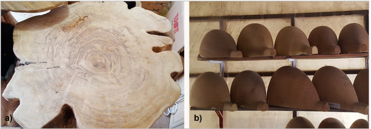
Şekil 5. Kestane kütüğünün dekoratif mobilya yapımı için işlenmesi (Türkeli-Sinop, a), kestane odundan üretilmiş bağlama tekneleri (Kastamonu, b).
