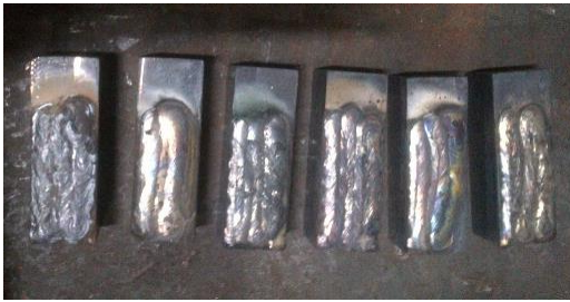
Şekil 2. Dolgu kaynağı yöntemiyle biriktirilmiş sert kaplama tabakaları
