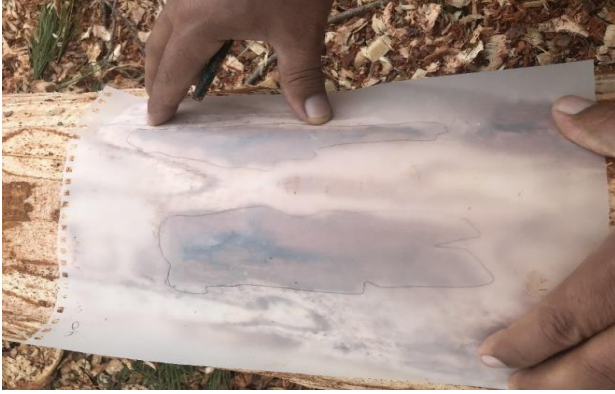
Şekil 8. Tomruk yüzeyinde kalan kabukların ölçülmesi
