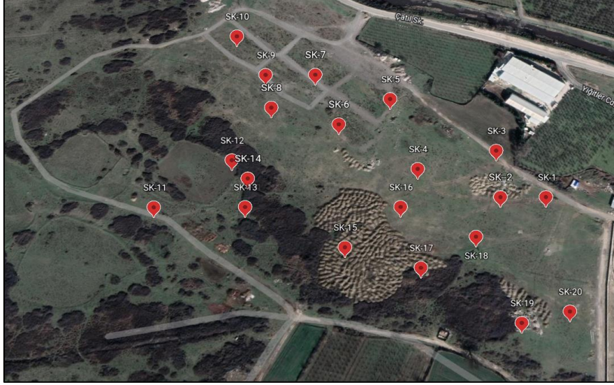
Şekil 2. Sondaj yerleşim planı (Borehole location plan)
