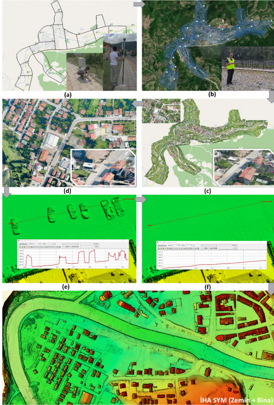
Şekil 5: İHA SYM verisinin üretilme aşamaları, a) uçuş planı ve YKN noktaları belirleme, b) stereo foto elde etme, c) nokta bulutu üretimi ve örnek alanı (Agisoft), d) zemin+bina nokta bulutunun oluşturulması (Cloud Compare), e) nokta bulutundan SYM verisinin üretilmesi ve örnek hata kesiti (ArcGIS Pro), f) SYM verisi üzerindeki hataların temizlenmesi (Quick Terrain Modeler) ve örnek kesiti.
