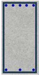
Şekil 4. Betonarme Bina Modellerinin Taşıyıcı Sistem Elemanlarına ait Kesit Detayları. (a) Kiriş Kesiti; (b) Kolon Kesiti.
