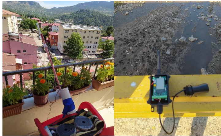
Şekil 1. LoRaWAN DLOS8 ağ geçidi ve LDDS75 mesafe sensörü Figure 1. LoRaWAN DLOS8 gateway and LDDS75 distance sensor
