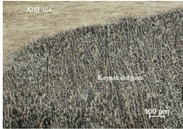
Şekil 5. 4 numaralı bölgede oluşan içyapı
