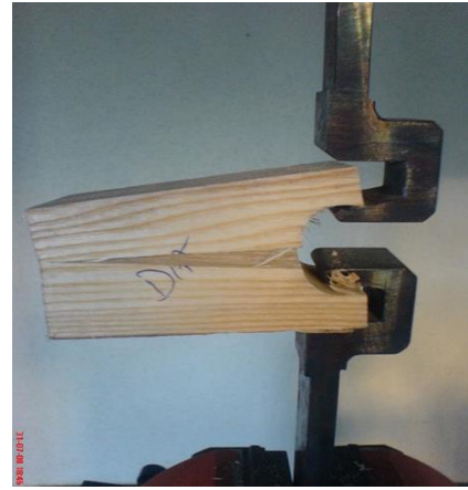
Şekil 9. Yarılma direnci deneyi
