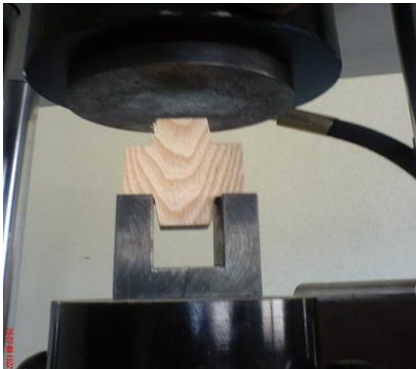
Şekil 8. Liflere paralel doğrultuda makaslama direnci deneyi
