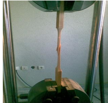
Şekil 11. Liflere paralel çekme direnci deneyi
