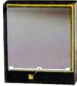
Şekil 4. ASD SiPM 3×3 mm.
