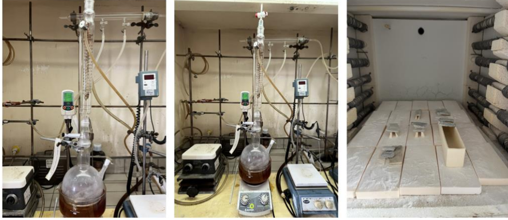
Şekil 3. Kaplama öncesi numunelerin dağlanma ve kuruma aşaması.
