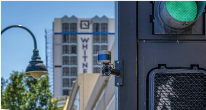
Şekil 5. Sürekli ölçüm yapan lidar ile araç ve yaya trafiği izleme [28,29]
