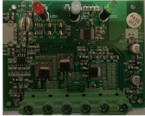
Şekil 9. Deneyde kullanılan şarj regülatörü devresi
