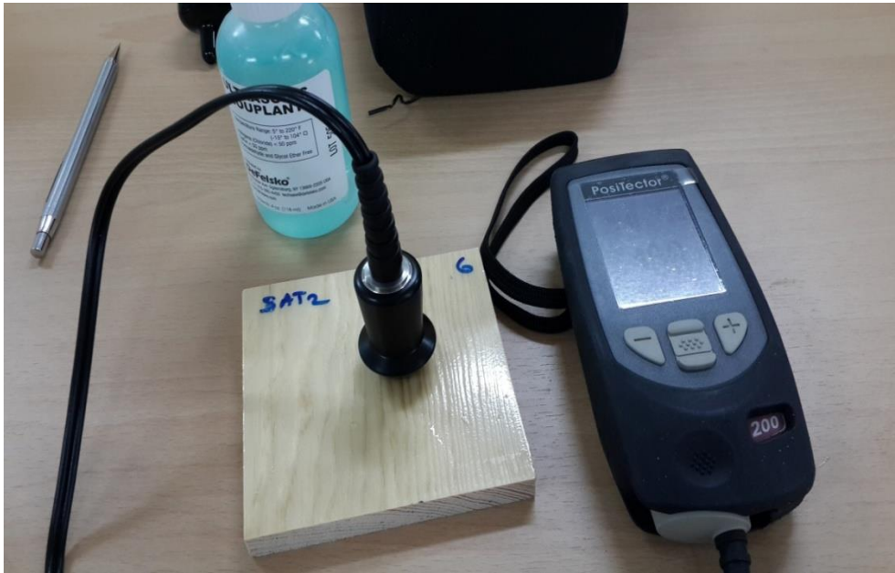
Şekil 4. Kuru film kalınlığının belirlenmesi
