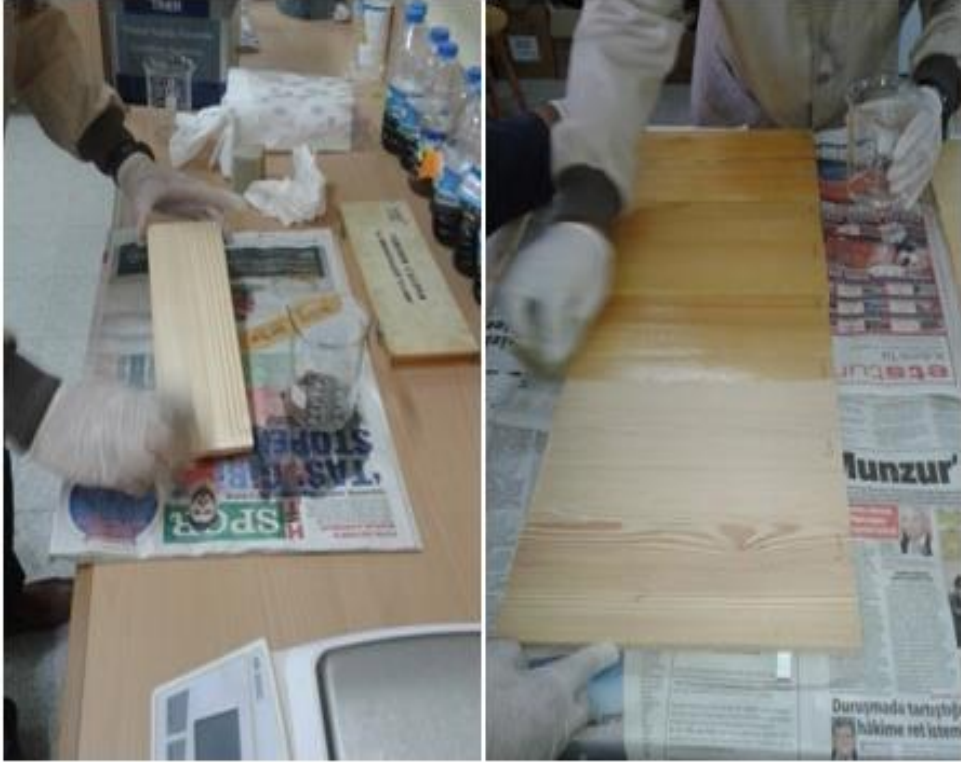
Şekil 2. Reçine temizleme işlemi
