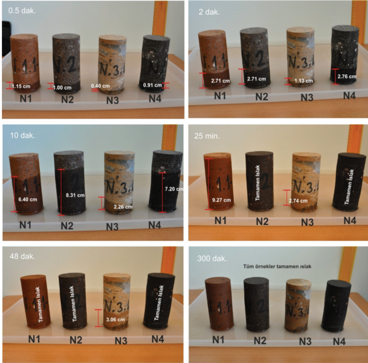
Şekil 5. İğnimbiritlerde kılcal su emme davranışına ait farklı zaman aralıklarında alınmış görüntüler.
