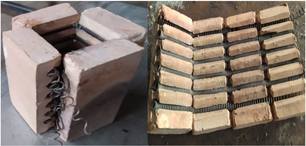
Şekil 2.1. Kanallı fırın taşı ve Nikrom direnç teli
