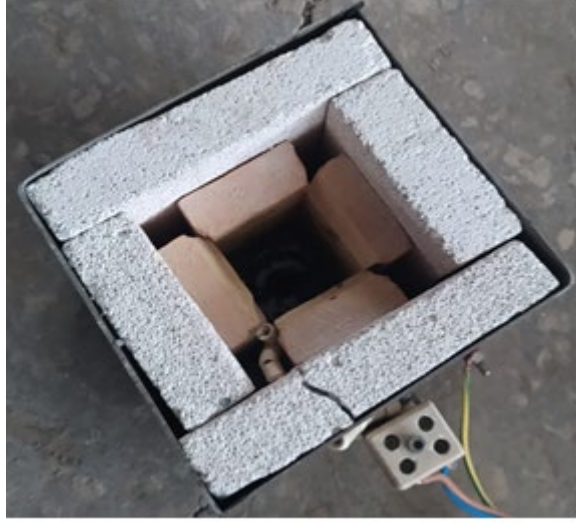
Şekil 2.2. Kanallı fırın taşların yalıtım malzemesinin içerisine montajı
