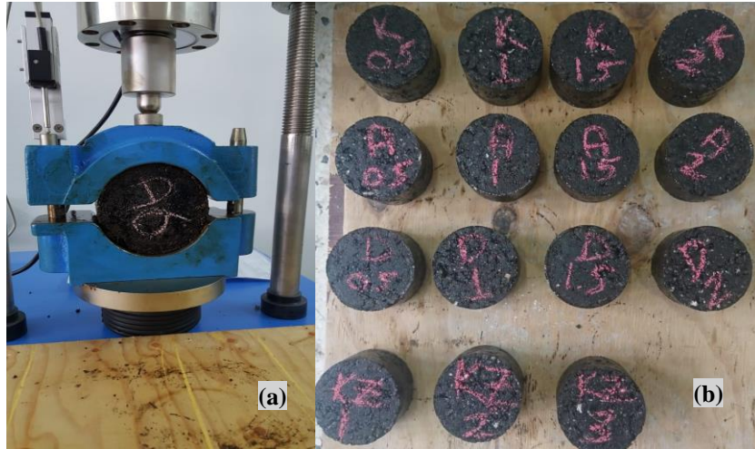
Şekil 1. Marshall stabilite deney aleti (a) ve briketler (b)
