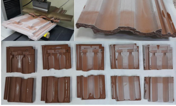
Şekil 13. Donmuş kiremitlerin kırılma halleri (-50 °C) (Fracture states of frozen roof tiles)
