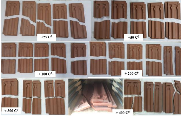
Şekil 14. Kiremitin kırılma halleri (Fracture states of roof tiles)
