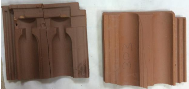
Şekil 15. Yüksek sıcaklıklarda kiremitlerde renk değişimi (Color change of roof tile at high temperatures)
