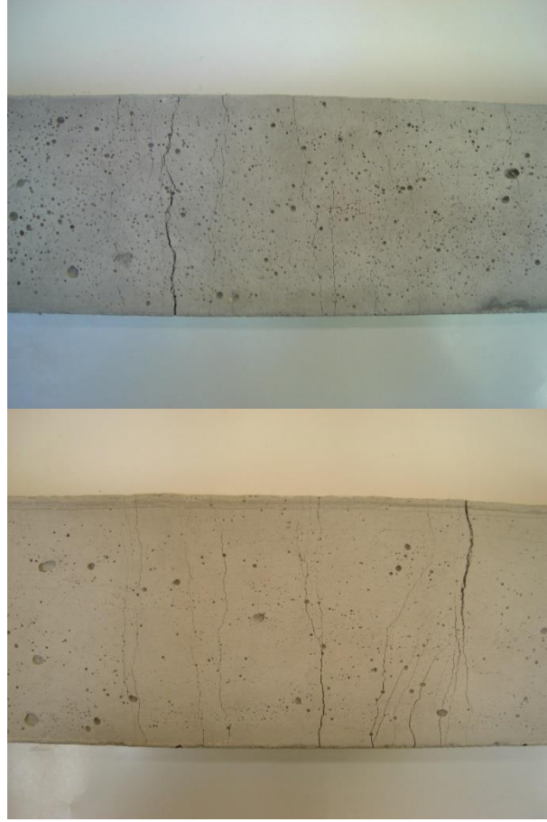
Şekil 4. Karışım #7 için temsili numunelerin çoklu çatlak dağılımı (Multiple crack distribution of representative samples for Mixture #7)
