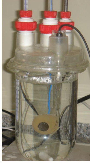
Şekil 8. Kaplamaların üretildiği elektrokimyasal hücre
