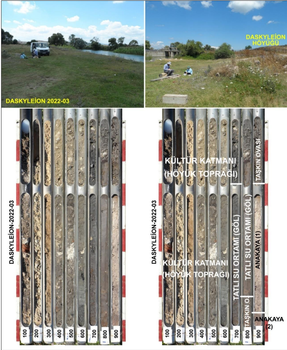
Şekil 9. Daskyleion Höyüğü'nün güneybatısında yapılan DSK 2022-03 numaralı sondaja ait sedimanlar ve yansıttıkları ortamlar.
