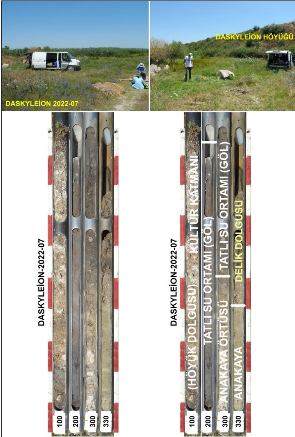
Şekil 11. Daskyleion Höyüğü'nün batısında, DSK 2022-01 sondaj noktası ile höyük arasında yapılan DSK 2022-07 numaralı sondaja ait sedimanlar ve yansıttıkları ortamlar.
